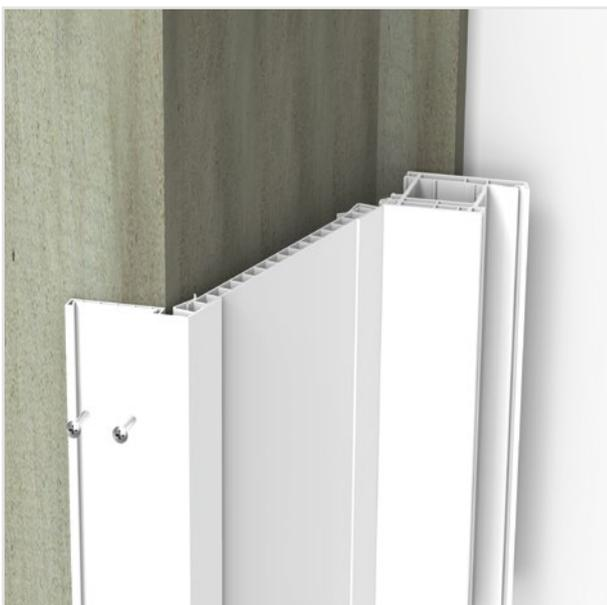
3 Das Abdeckprofil mit der Wand verschrauben.
