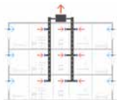
MFH zentrales Lüftungsgerät
